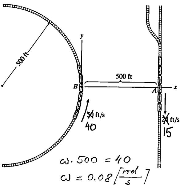
$$\dot{\vec{v}}_A = \dot{\vec{v}}_B + \dot{\vec{v}}_{\text{rel}} + \vec{\omega} \times \vec{BA}$$
